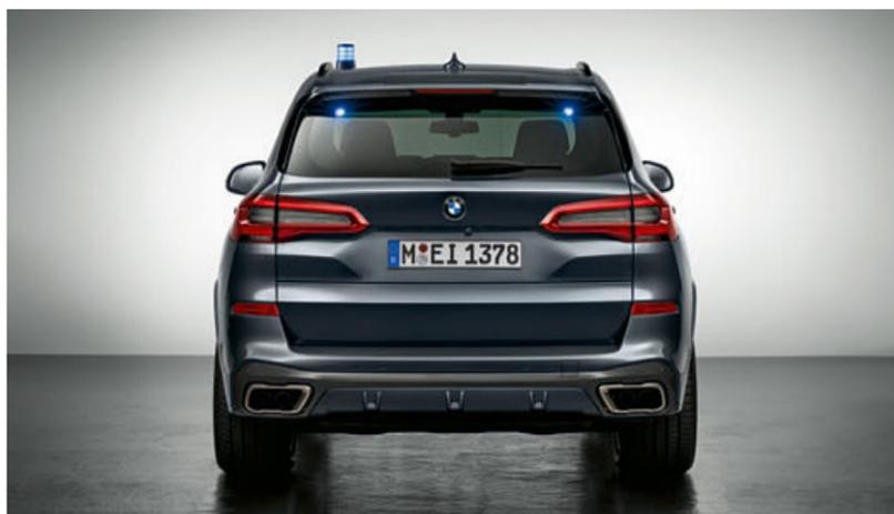
Zusätzliche **Blitzer**<sup>1</sup> an der Heckscheibe warnen den rückwärtigen Verkehr.
