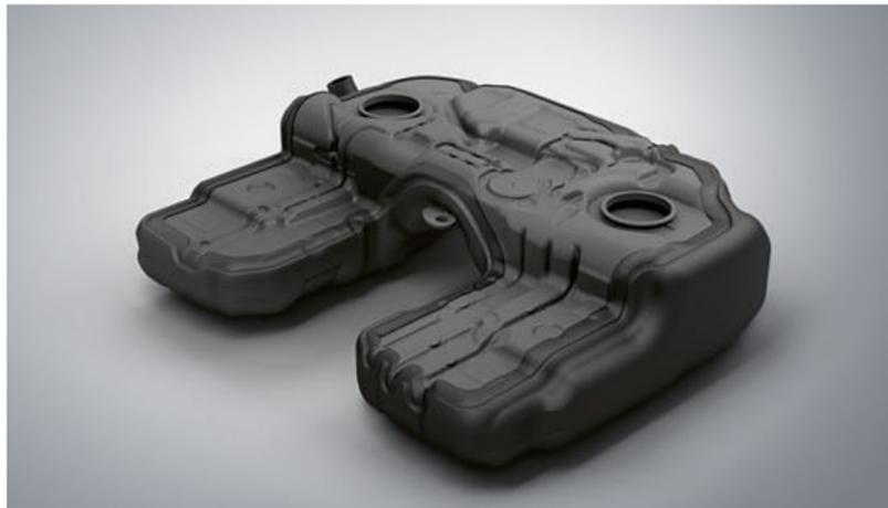
**Auslaufhemmender Tank:** Die serienmäßig ummantelte Außenhaut des Tanks verschiebt sich nach Beschuss selbstständig und unterbindet das weitere Auslaufen von Kraftstoff.
