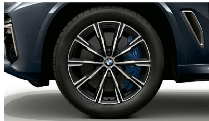
Die **M Sportbremse** mit Vierkolben-Festsattel vorn und Einkolben-Faustsattel hinten in Blau sowie mit M Schriftzug verfügt über größere Bremscheiben und damit über eine besonders hohe Bremsleistung.
