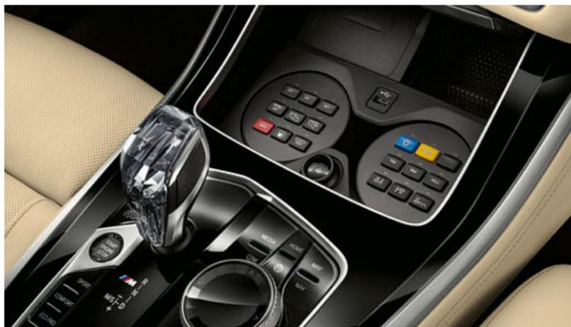
Die **Sondersignalanlage**<sup>1</sup> beinhaltet eine abnehmbare Rundumkennleuchte, Frontblitzer in der Niere sowie das Tonfolgesignal. Sämtliche Bedienelemente sind in einem Schaltzentrum vor dem Gangwählhebel zusammengefasst.
