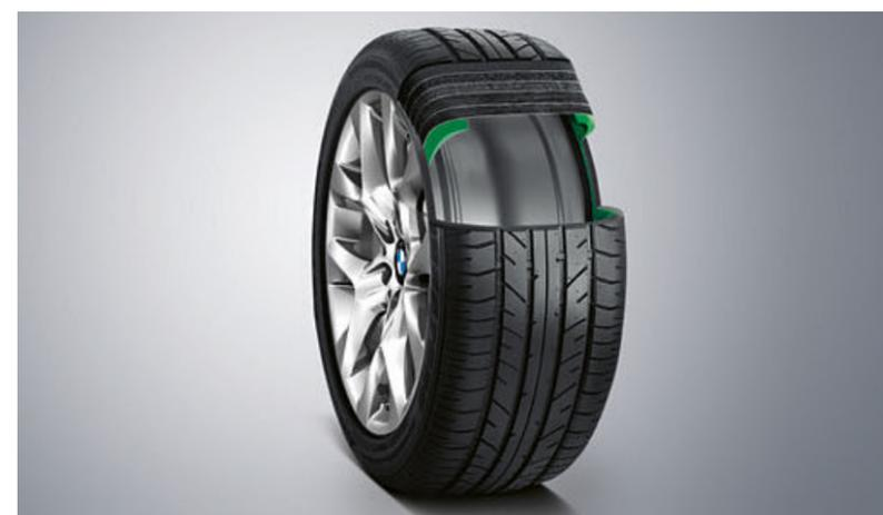
Der neue BMW X5 Protection VR6 verfügt serienmäßig über Mischbereifung mit **Notlaufeigenschaften**. Diese Reifen können bei einem plötzlichen Druckverlust dank verstärkter Flanken nicht von der Felge springen und erlauben so eine Weiterfahrt bis zur nächsten Werkstatt.
