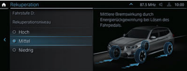
Het recuperatiesysteem zet de kinetische energie die vrijkomt bij uitrollen en remmen om in stroom en slaat deze op in de hoogvoltage-accu.
